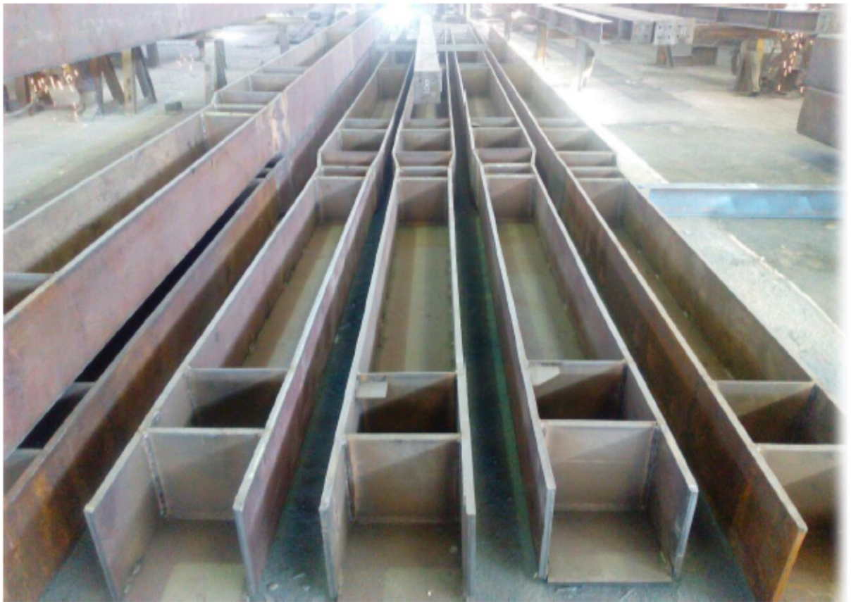
کارگاه ساخت ستون ها
